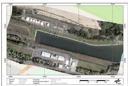
Echtzeit-Übertragung von hochau aufgelösten, georeferenzierten Bilddaten als Kartenmosaik* an das Einsatz- und Lagezentrum * patentiertes Verfahren von DLR-OS
