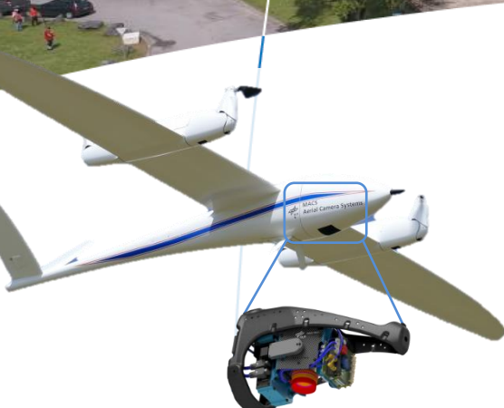
Luftgestützte Bildaufnahme am Beispiel eines UAV mit integriertem MACS-Kamerasystem* * Entwicklung DLR-OS
